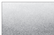
Edelstahl Oberfläche rotex-geschliffen Werkstoff-Nr.: 1.4404, V4A
