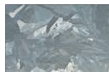
Stahl feuerverzinkt nach DIN EN ISO 1461
