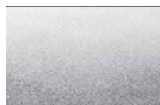
Edelstahl Oberfläche rotex-geschliffen Werkstoff-Nr.: 1.4404, V4A
