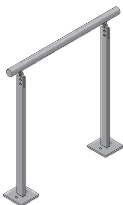
Flachpfosten 2x Flach 50x8 mm 2 mit Grundplatte 150x150 mm 2
