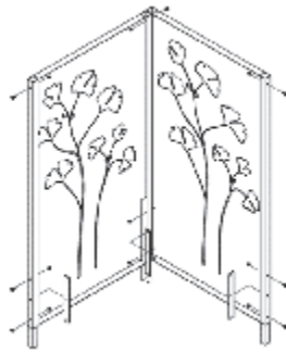
Direkte Verschraubung von zwei Motivwänden als Außenecke (Bild von hinten)
