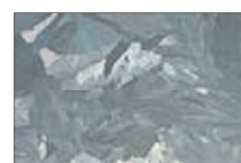
Stahl feuerverzinkt nach DIN EN ISO 1461
