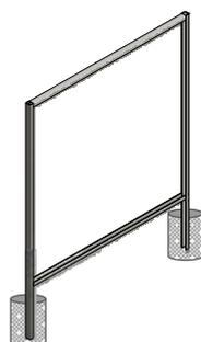
Cornice per fissaggio in zoccoli di beton (standard)
